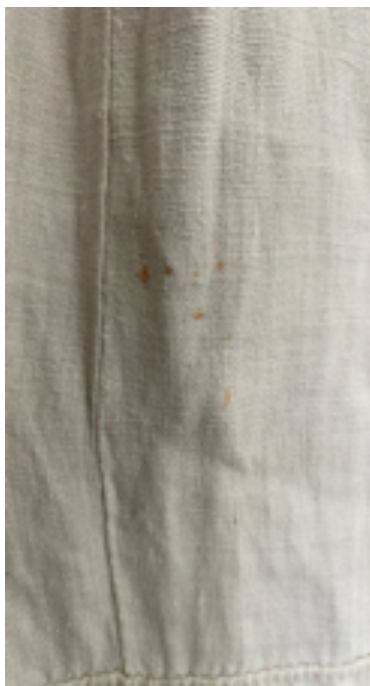
Рисунок 6 — Пятна ржавчины Figure 6 — Rust spots
